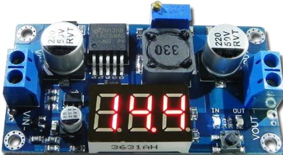
Dieses kleine und kompakte Modul eignet sich hervorragend, um z.B. während eines Schaltungsentwurfes eine Hilfsspannung zu erzeugen oder aus einem unregelmäßigen Netzteil eine stabilisierte Spannung zu gewinnen. Mit Hilfe des Trimmers kann eine Ausgangsspannung zwischen 1,5V und 35V eingestellt werden. Das LED Voltmeter kann die Eingangs- und Ausgangsspannung anzeigen.
